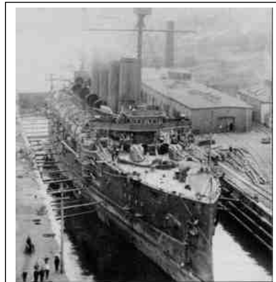
La coque du Niobe , NCSM, avariée lorsque ce dernier s'échoua sur l'île de Sable, est réparée en cale sèche. Halifax 1911.
