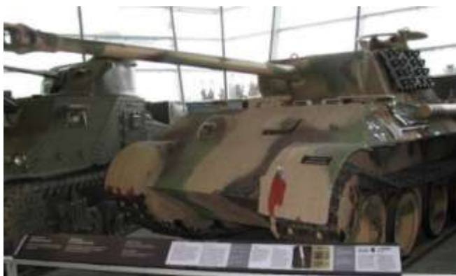
Image 3 : Le canon KwK 42/L70 sur le Panther Mk V du Musée. La large tourelle permettait de tirer à 360 degrés, mais il y avait un coût : un large châssis et un tank très lourd.
