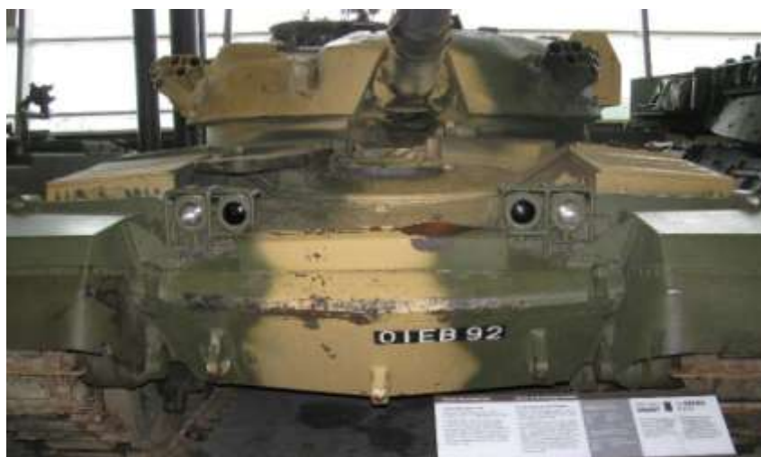
Image 20 : Le blindage imposant à l'avant du Chieftain du Musée. Des lance-grenades fumigènes sont posés sur la tourelle pour protéger le tank contre les attaques au missile.
