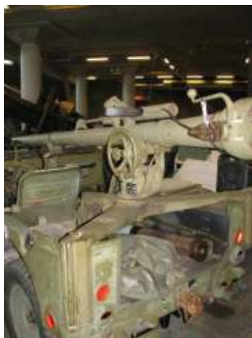
Image 14 : Un canon BAT américain de 106 mm posé sur un Jeep. Puisque c'était un canon sans recul (et que la douille perforée était visible), il produisait un souffle arrière observable par l'ennemi. Par conséquent, il était crucial qu'il puisse atteindre sa cible du premier coup et battre en retraite rapidement. Le Musée possède aussi un canon soviétique similaire utilisé par la Syrie.
