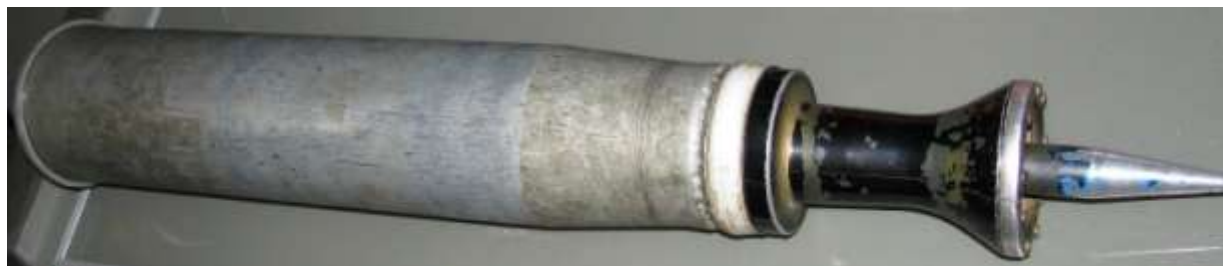
Image 2 : Un APFSDS de 105 mm. Le sabot est le cône noir qui entoure la tige traversant l'ogive jusque dans la douille.
