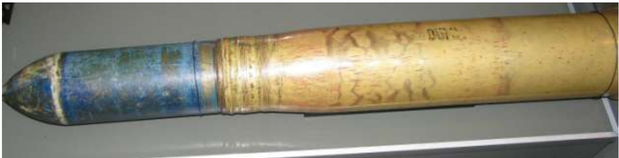
Image 19 : Un projectile factice de 105 mm qui reprend la forme de base d'un projectile HESH. Ce type de munition est très utile contre des blocs de béton.
