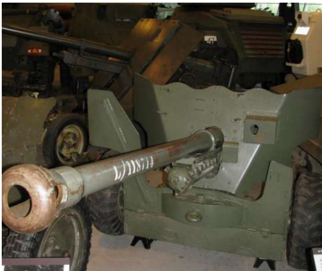
Image 5 : Le canon antichar britannique de 6 livres du Musée. Avec son angle de tir de 90 degrés et son poids de 1000 lb, il était facilement manœuvrable. Même lorsque le blindage allemand est devenu à son éprouve vers la fin de la guerre, c'était encore une bonne arme d'appui d'infanterie.
