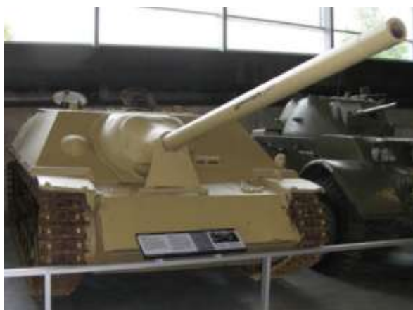
Image 4 : Le même canon posé cette fois-ci sur un chasseur de chars. Le poids supplémentaire du fusil et du blindage rajoutait une charge sur le nez du véhicule, ce qui exigeait de renforcer les roues avant des chenilles.
