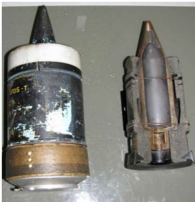
Image 1 : Un obus perforant à sabot détachable a été coupé à la verticale pour montrer comment il est fait. Le projectile rigide est recouvert d'une coiffe et d'une enveloppe de métal doux avec une coiffe balistique. À sa gauche se trouve une version de 105 mm avec son sabot détachable ; la marque du traceur est parfaitement visible.
