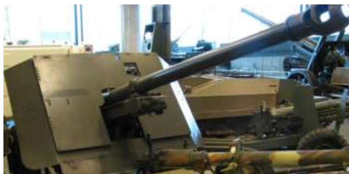
Image 6 : Le canon antichar de 17 livres. Sa performance était similaire à celle du canon allemand de 88 mm, et peut-être même meilleure, mais son poids de 3 tonnes le rendait difficile à manœuvrer sur le champ de bataille.
