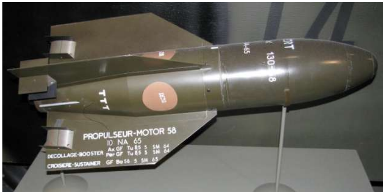
Image 16 : L'ENTAC de la France, l'un des tout premiers missiles guidés antichars. On peut voir le fil de guidage de cuivre au bas du corps du projectile. Les signaux émis par le joystick de l'opérateur étaient transmis aux axes de tangage et de lacet du missile par l'entremise des volets aux couleurs pâles.
